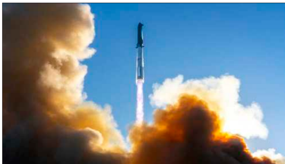
▲ El combustible que se filtraba acumuló presión en la cavidad sobre el cortafuegos del motor; el incendio resultante habría provocado la desintegración de la nave espacial. Foto @SpaceX
