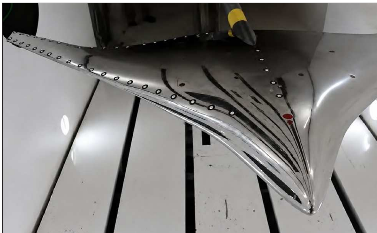
▲ Los ensayos analizaron su comportamiento aerodinámico, estabilidad y deformación estructural. Foto Sputnik
