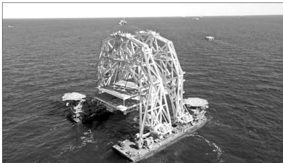
▲ La estructura de la plataforma Maloob E pesa 8 mil toneladas y mide 88.39 metros. Foto facebook @soloplatasformeros
