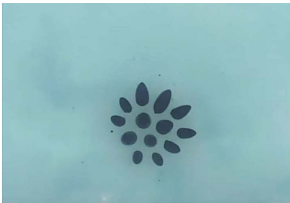
▲ Los robots de ferrofluido funcionan con la fuerza de imanes esféricos giratorios, que les permiten romperse en pedazos para atravesar pasillos estrechos. Foto Captura de pantalla
