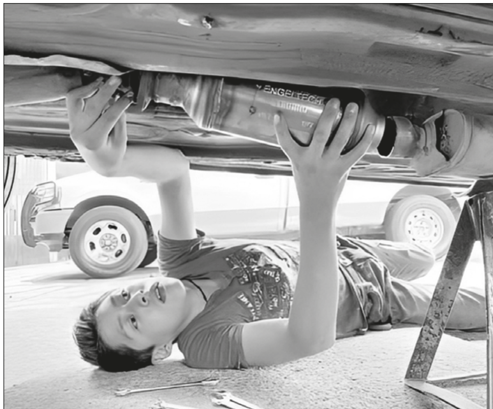
▲ Los catalizadores o convertidores catalíticos sirven para que 90 por ciento de los gases dañinos del escape de un vehículo se transformen en sustancias menos tóxicas. Foto Luis Castillo
