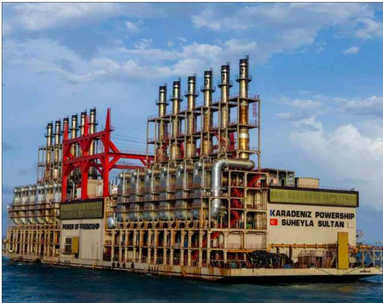
▲ El Karadeniz Powership tiene una turbina que convierte la energía calorífica que producen sus 12 generadores en más electricidad, con una capacidad óptima del 47 al 50 por ciento en comparación con las menores eficiencias de las plantas en tierra firme. Foto Cortesía
