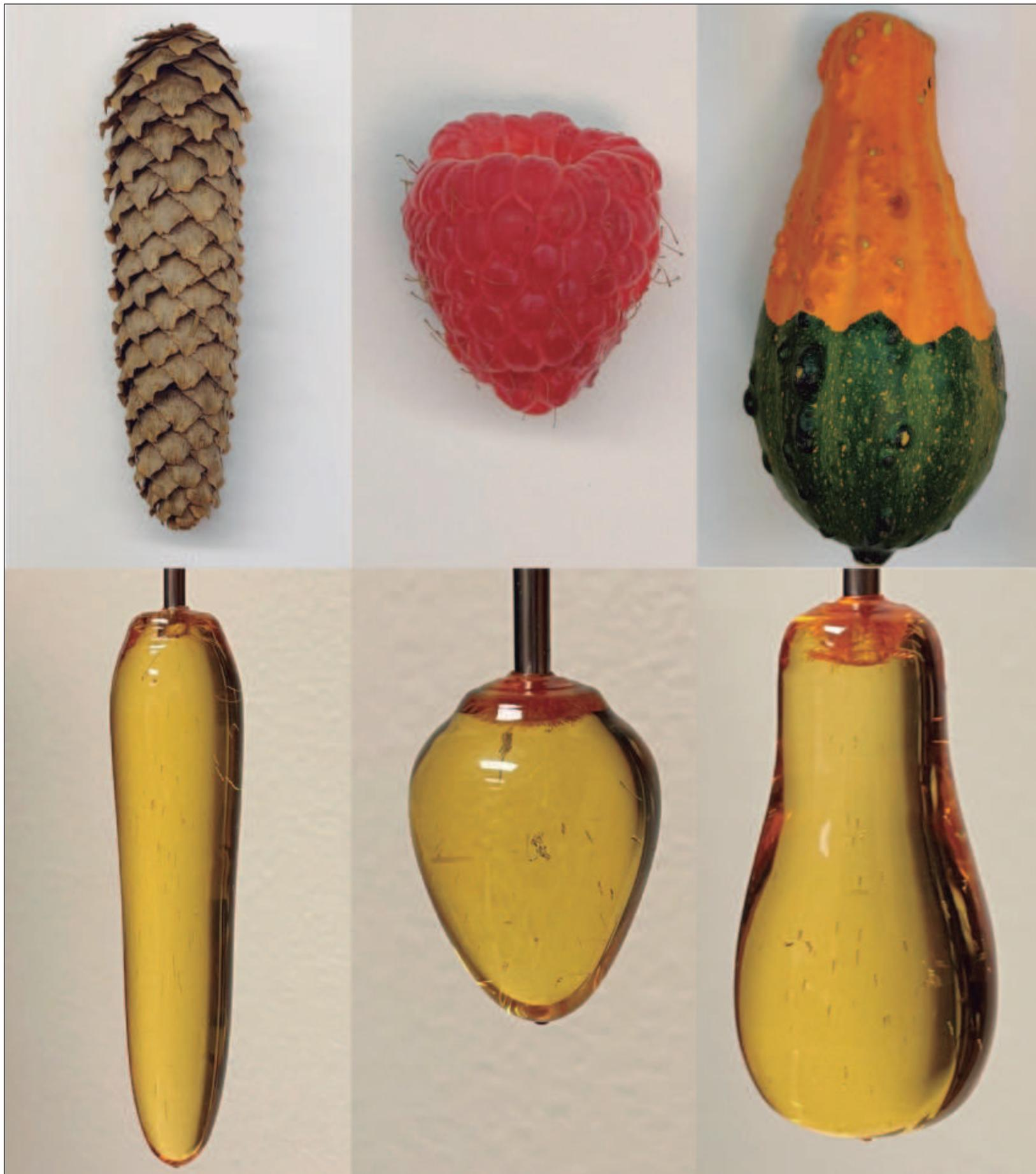
▲ Un nuevo sistema de impresión 3D que imita la expansión de los troncos de los árboles ha sido utilizado para imprimir piezas de polímero de forma rápida y eficiente sin moldes ni costosos equipos. Investigadores del Grupo
