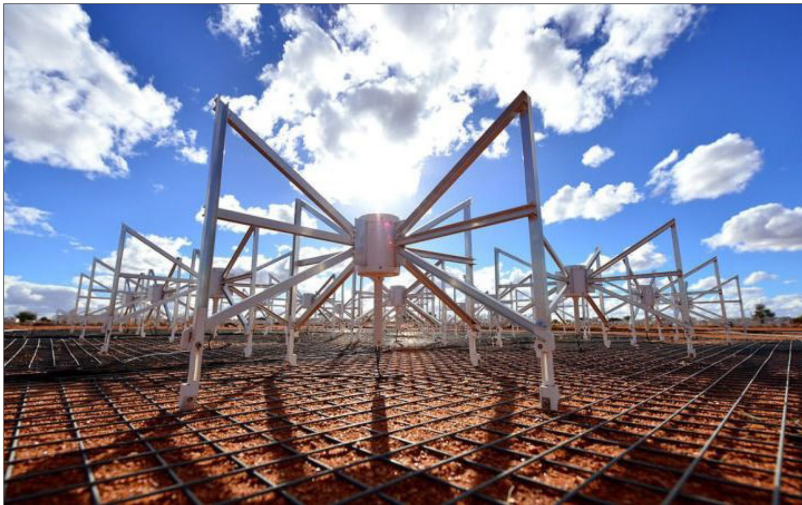
Antenas dipolo del telescopio Murchison Widefield Array, instalado en Australia Occidental. Foto Icrar/ Dragonfly Media
