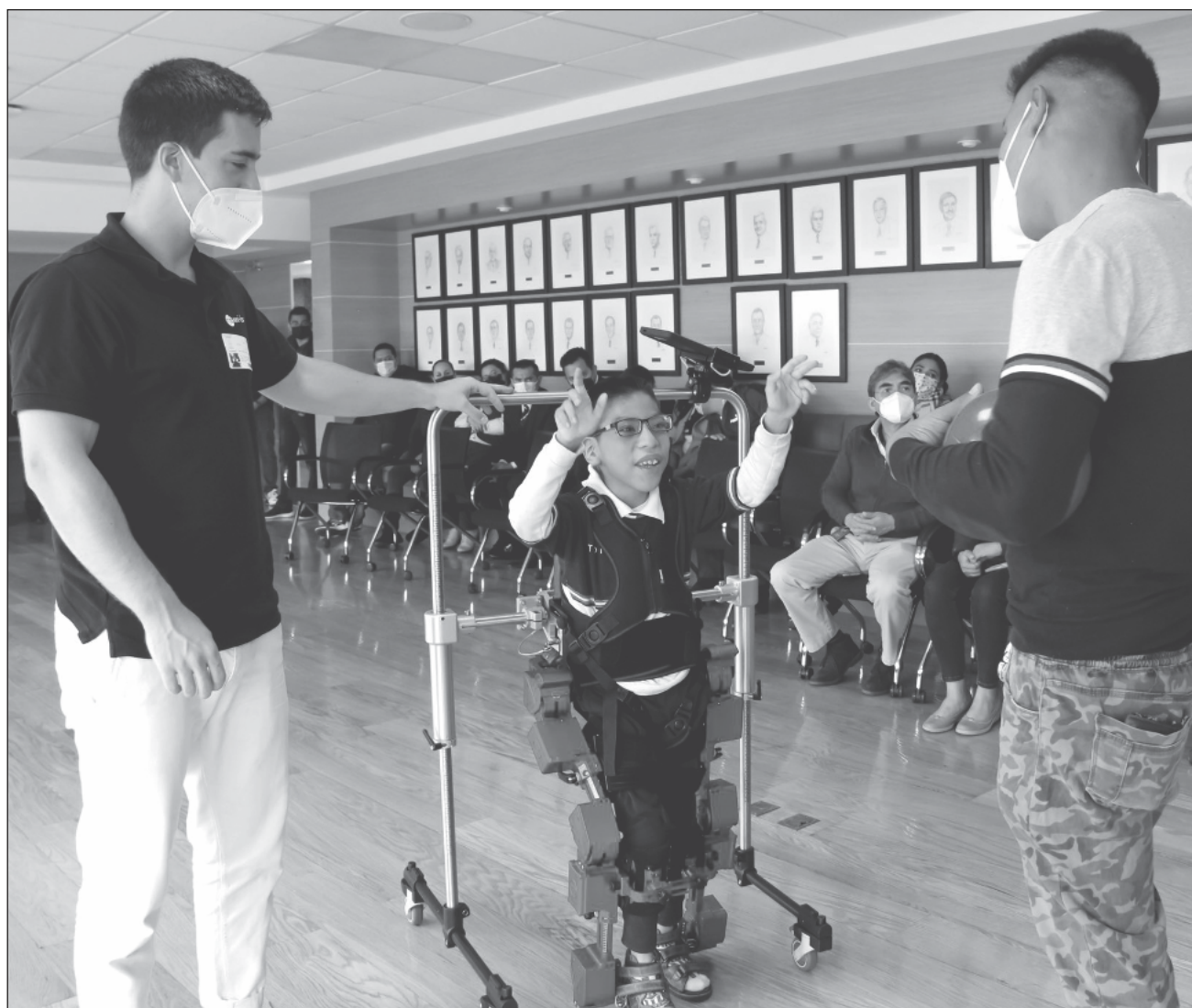
▲ El dispositivo sujeta a la persona usuaria desde el tronco hasta los pies y está compuesto por ocho articulaciones activas que ayudan a la movilidad en todas las direcciones; en cinco minutos puede estar de pie. Foto @FundCAAAREM
